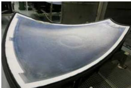
Figure 14. Ø5.4m ULPM LH2 dome segment
