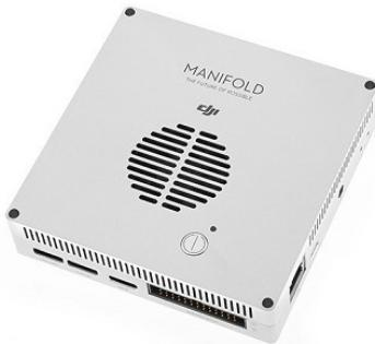
그림 3. DJI 임무컴퓨터(Manifold)
