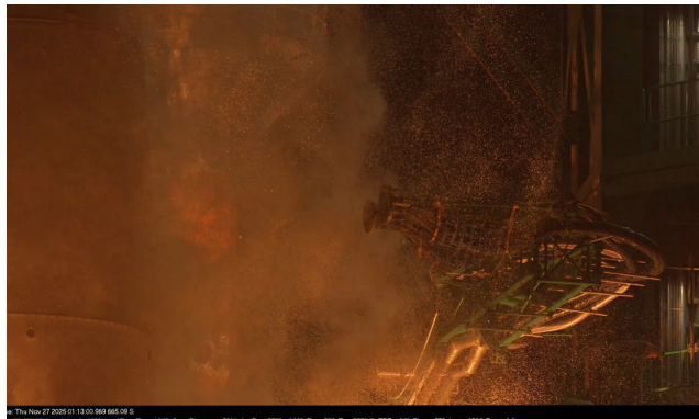
누리호 4차 발사 이륙순간 엠티리칼 장치 분리 장면 #1 Separation of the Umbilical System at Liftoff during the Nuri 4th Launch #1
