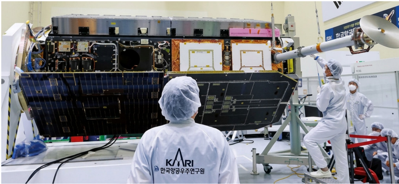
다목적실용위성 6호 X대역 안테나 장치 전개시험 Deployment Test of the KOMPSAT-6 X-band Antenna
