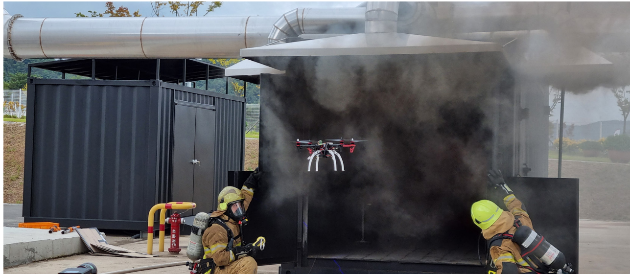
실내수색 드론 실화재 시험 Real-Fire Test of the Indoor Search Drone
