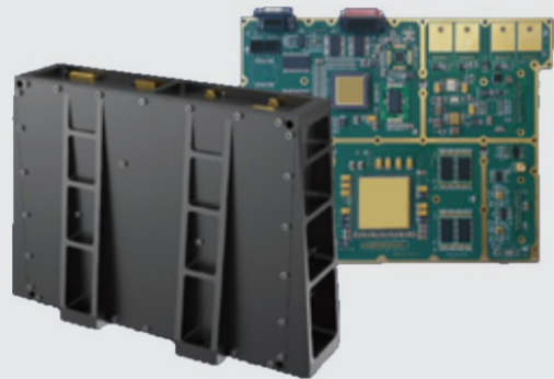
정지궤도 위성용 GNSS 수신기 Multi-GNSS Receiver for GEO Satellites
