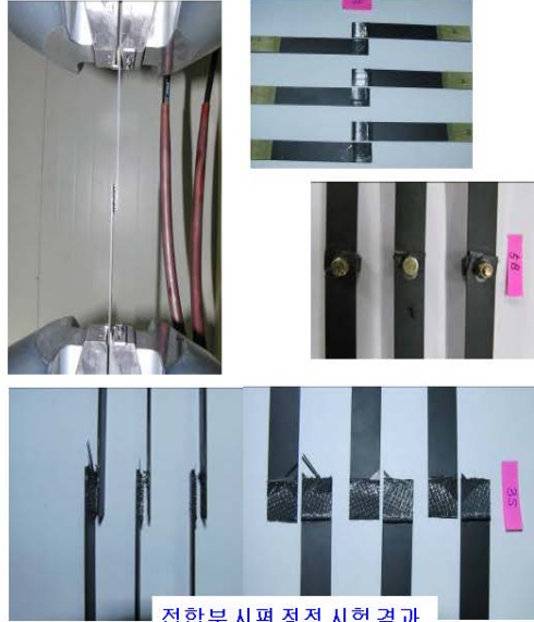
접합부 시편 정적 시험 결과
