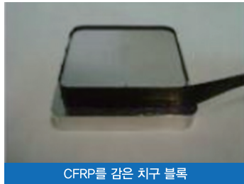
CFRP를 감은 치구 블록
