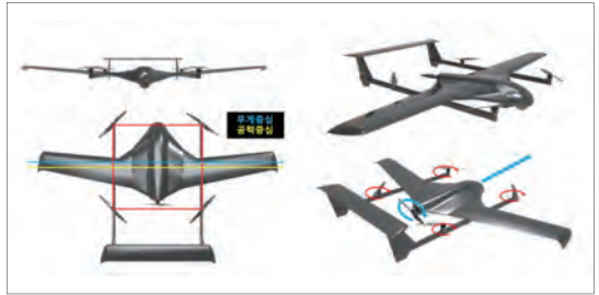
10kg 적재중량에 4시간 임무 수행이 가능한 Hybrid 고정익 VTOL 무인비행체
