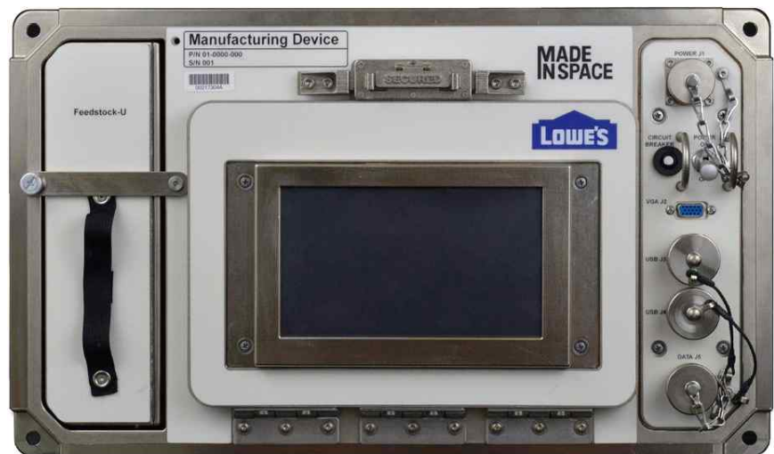
[그림 12] ISS에 설치된 Made In Space의 3D 프린터 8) 출처: Made In Space 홈페이지( www.madeinspace.us )
